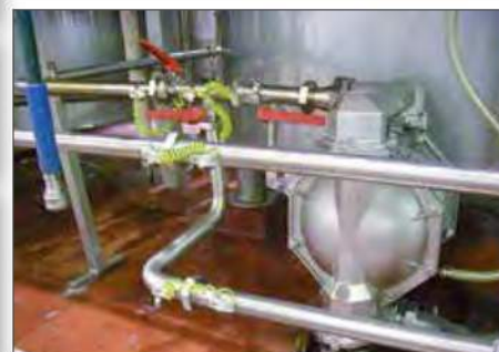
Eine 3" (76,2 mm) Hygienepumpe eingesetzt zur Förderung von kosmetischen Bestandteilen bei der Shampooherstellung.
